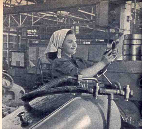
Работница Молдовского завода шарикоподшипников Вероника Яков работает на 4-резцовом автоматическом станке для отделки шарикоподшипниковых колец.
